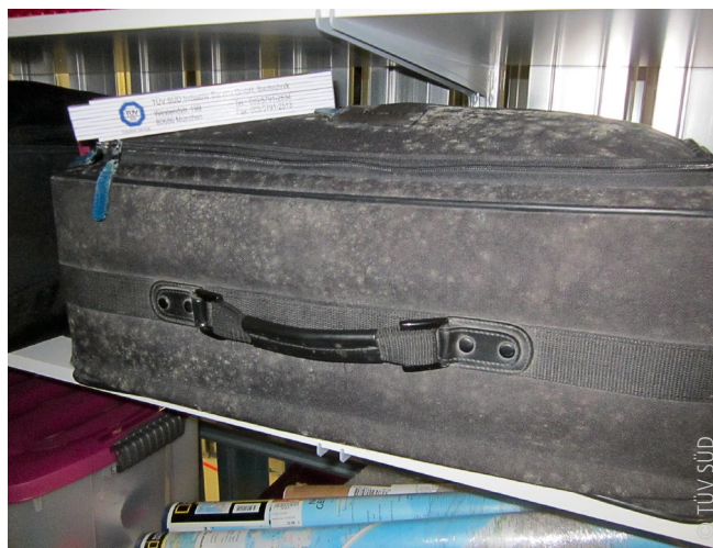
Abb. 2: Schimmelpilzbildung an einem Koffer. Ursache ist hohe relative Raumluftfeuchte und die Schimmelanfälligkeit des Lagerguts.
