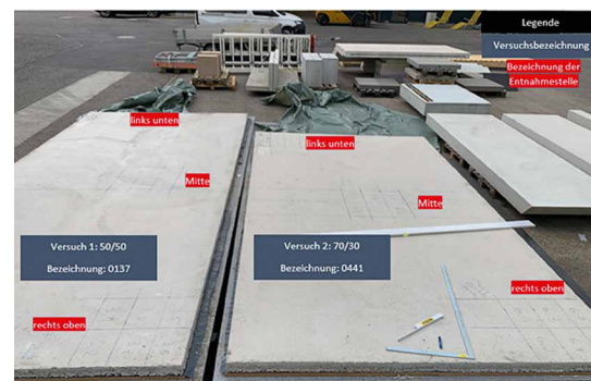
Abb. 12: Entnahmebereiche für die Prüfungen an den erhärteten RC-Estrichen [© Georg Reisch GmbH & Co. KG]
