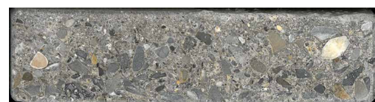
Abb. 13: Gleichmäßiges Gefüge des RC-Estrichs mit Typ-1-Körnungen [© Georg Reisch GmbH & Co. KG]
