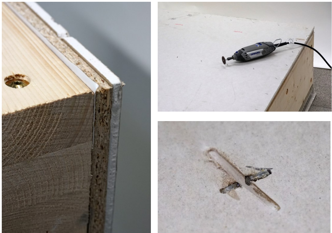
Abbildung 102: Trennung der Gipskartonplatte von der Spanplatte (eigene Darstellung)
