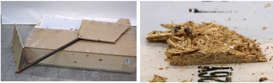
Abbildung 103: Trennung der Spanplatte vom Holzständerwerk (eigene Darstellung)
