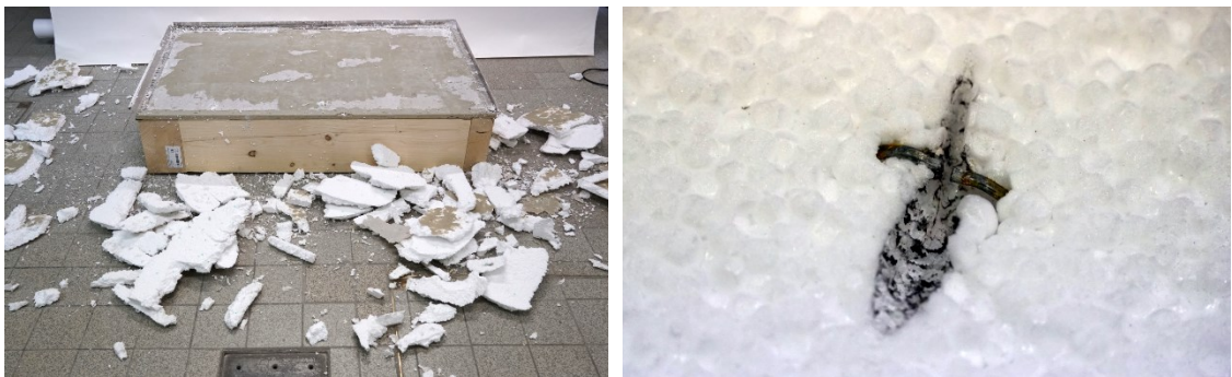
Abbildung 106: Trennung der EPS-Dämmplatte von der zementgebundenen Spanplatte (eigene Darstellung)
