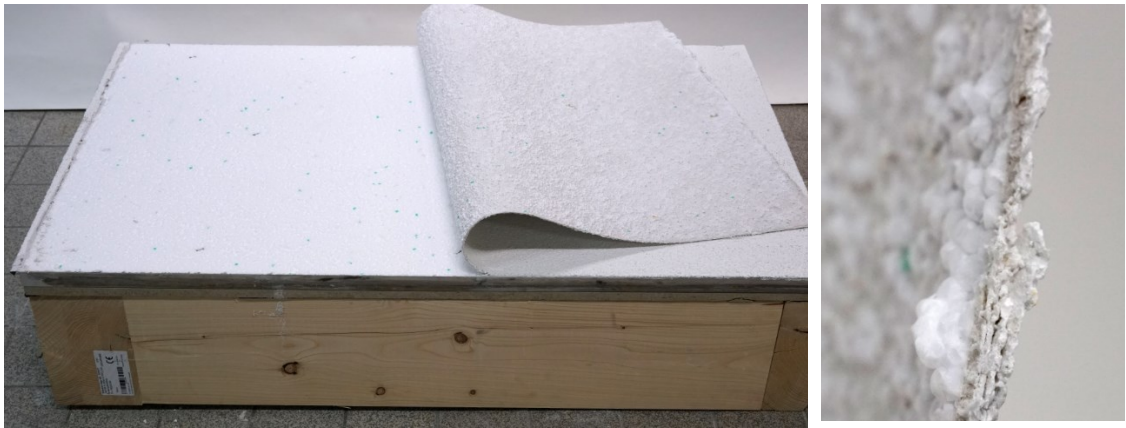
Abbildung 105: Trennung des Putzes mit Armierung von der EPS-Dämmplatte (eigene Darstellung)
