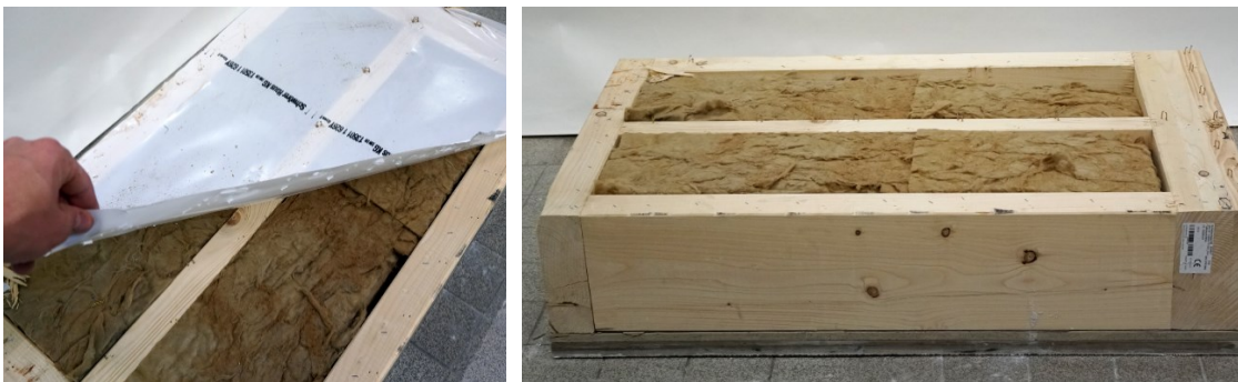
Abbildung 104: Trennung der PE-Folie vom Holzständerwerk (eigene Darstellung)
