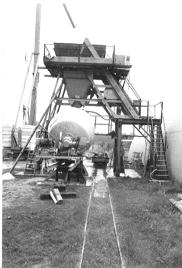
Abb. 4 Versuchsaufbau mit Entnahmeeinrichtung
