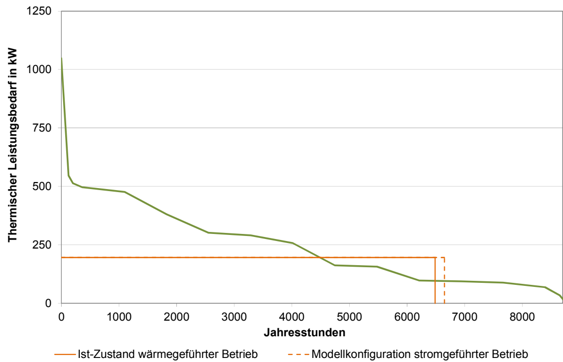
Abbildung 66: Jahresdauerlinie BHKW Modellkonfiguration Anlage Nr. 6
