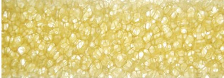
Abbildung 103: Acrylharzinfiltrierter PUR-Schaum, 10 ppi (Porendurchmesser: 2 bis 3 mm)
