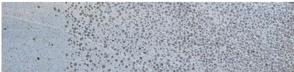
Abbildung 75: Mittels zweier Sprüngeräte realisierter Porositätsgradient (Zylinder 10 x 40 cm)
