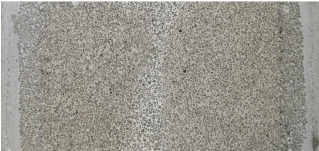
Abbildung 81: Gradientenbetonwand mit Blähglaskern (Wandstärke 40 cm)
