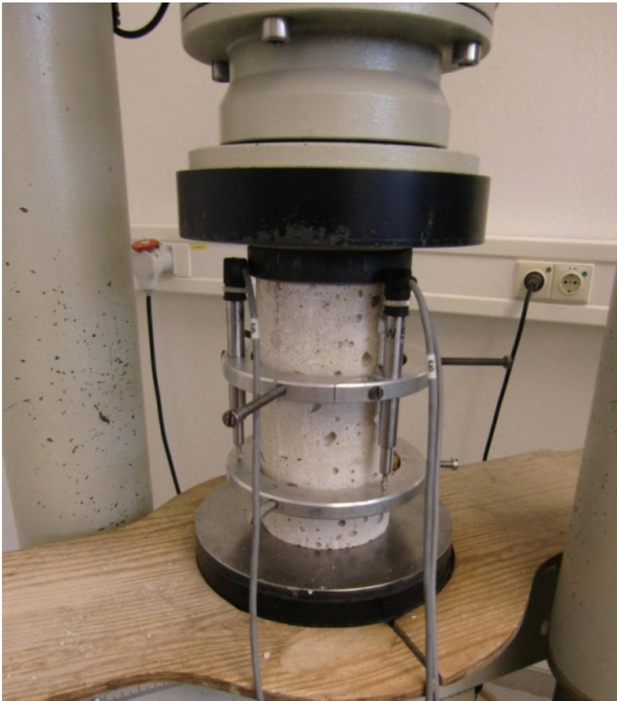
Abbildung 28: Wegaufnehmer an Zylinder (15 x 30 cm) zur Elastizitätsmodul-Prüfung
