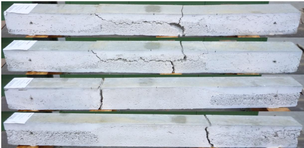
Abbildung 155: SV5: Bruchbilder der Prüfkörper
