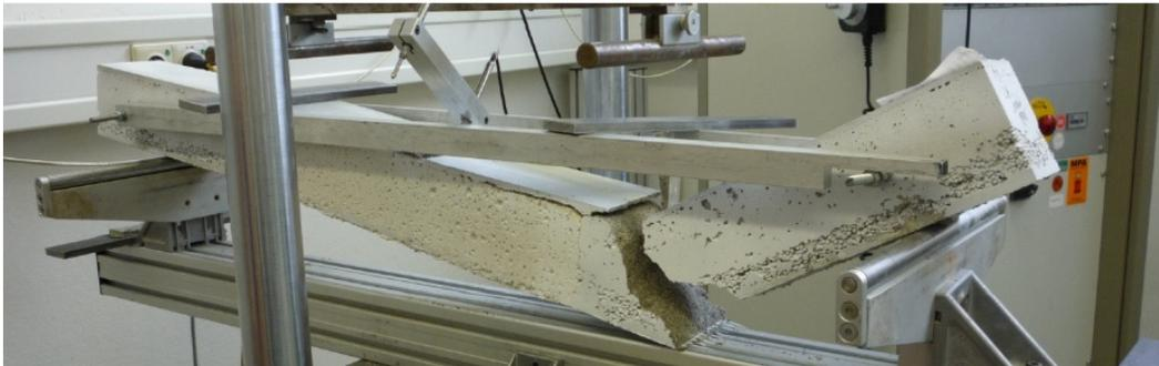
Abbildung 91: Gradientendecken Prüfkörper Vorversuch (Balken 10 x 10 x 120 cm)
