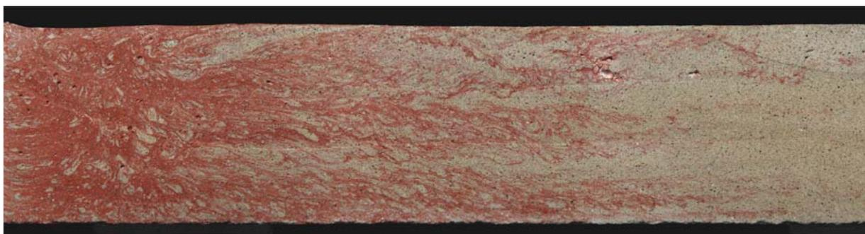
Abbildung 71: Gradierung der Pigmente über die Bauteillänge (Schnitt Zylinder 10 x 40 cm)
