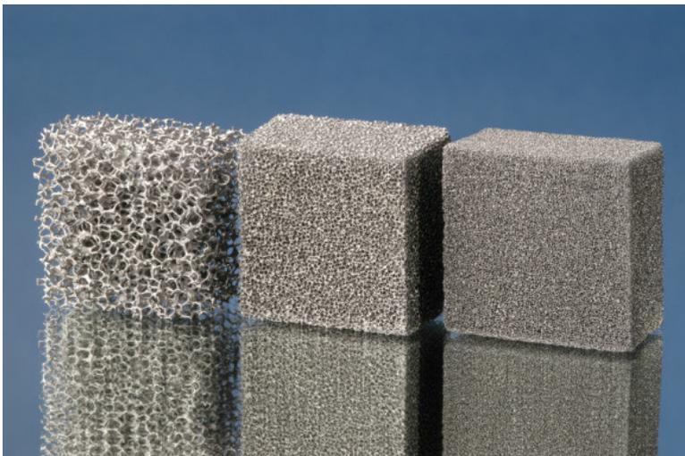
Abbildung 108: Metallschäume als Replikate von PUR-Schäumen [57]
