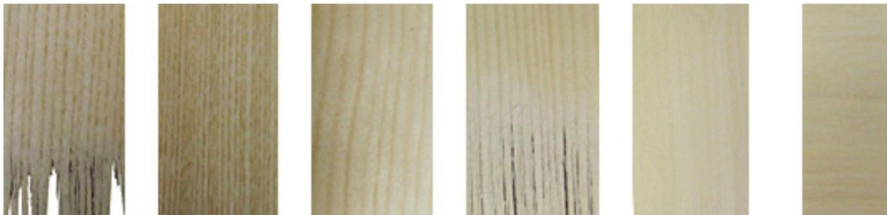
Abbildung 134: Furnierstreifen: von links nach rechts: Esche aufgeraut, Esche unbehandelt, Fichte unbehandelt, Fichte aufgeraut, Bambus mit Längsfaserformat, Bambus mit Querfaserformat (Probekörper:  $l \times b \times h = 120 \times 50 \times 1 \text{ mm}$ )
