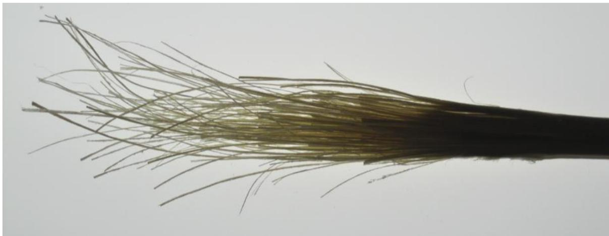
Abbildung 143: Durch Hämmern aufgetrennte und abgestufte Bambusfasern (Probekörper  $b=10\text{ mm}$ )
