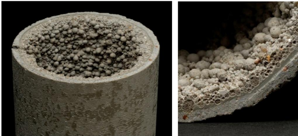
Abbildung 59: *Kontrolliertes Entmischen in einer Zentrifuge (Durchmesser 10,5 cm, Wandstärke ca. 2 cm); Ansicht Probekörper (links), Ausschnitt (rechts)*
