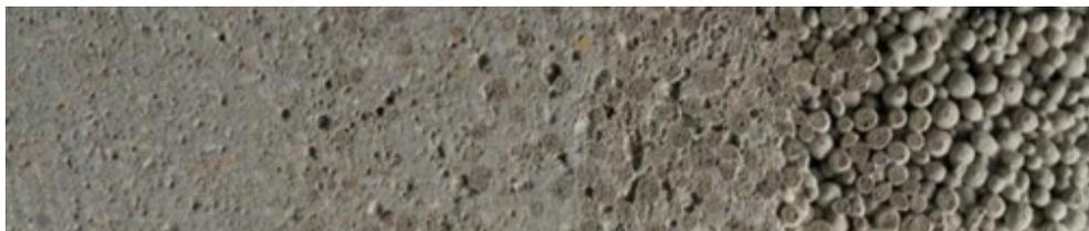
Abbildung 55: Porositätsgradient, geschichtet, Zuschlag (Blähglas), Prisma 4 x 4 x 16 cm
