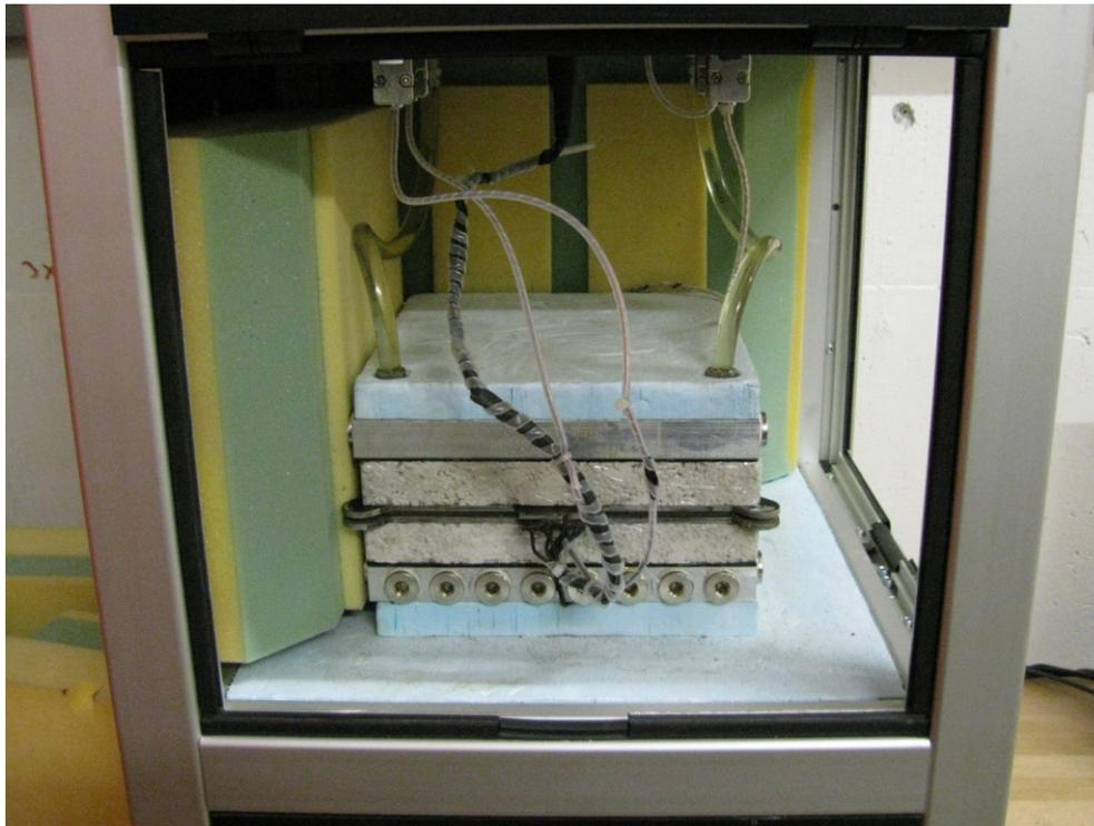
Abbildung 29: Zweiplattengerät mit Versuchsaufbau (Platten: 20 x 20 x 3 cm)
