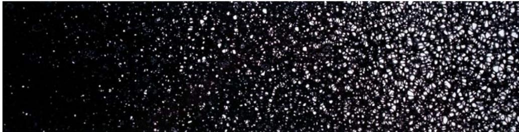
Abbildung 107: Gradiertes PUR-Schaum in Polyesterharz (Probekörper:  $l \times b \times h = 210 \times 55 \times 15 \text{ mm}$ )
