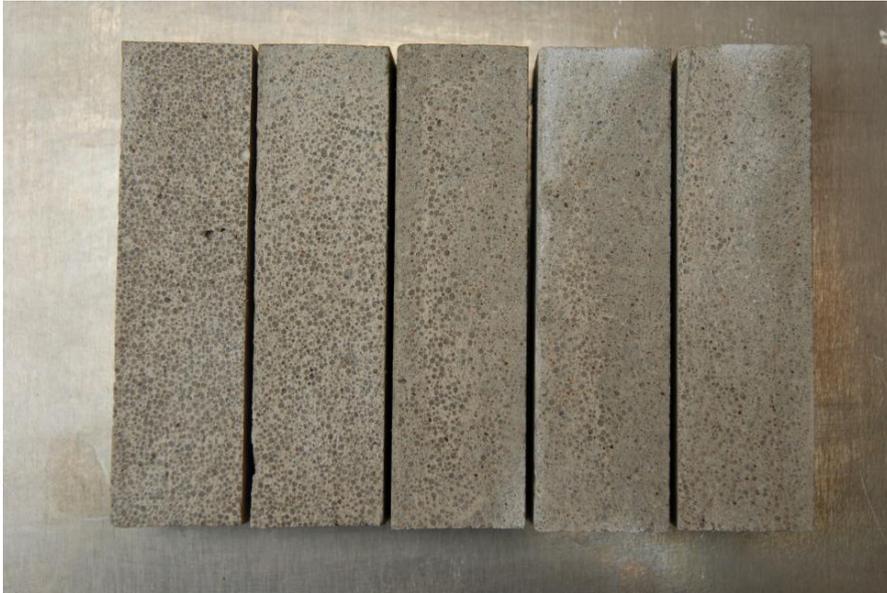
Abbildung 76: Mörtelprismen gesägt aus Gradientenprobekörper (4 x 4 x 16 cm)
