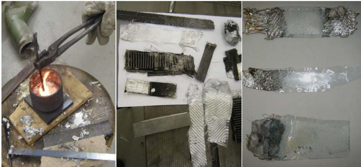
Abbildung 127: Herstellen erster Probekörper mit einem gradierten Matrixübergang von Harz zu Metall
