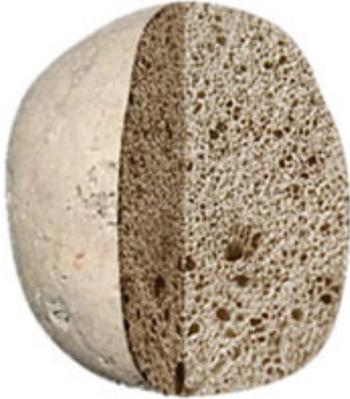
Abbildung 23: Liaver-Korn, Korndurchmesser 4 mm [1]
