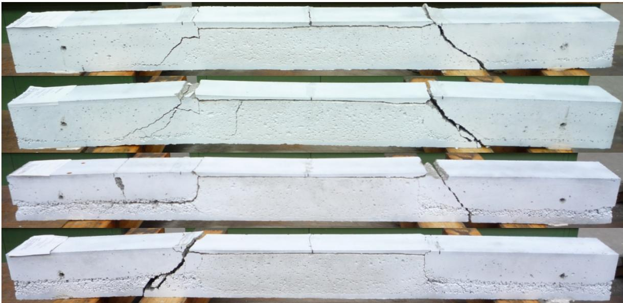
Abbildung 149: SV3: Bruchbilder der Prüfkörper
