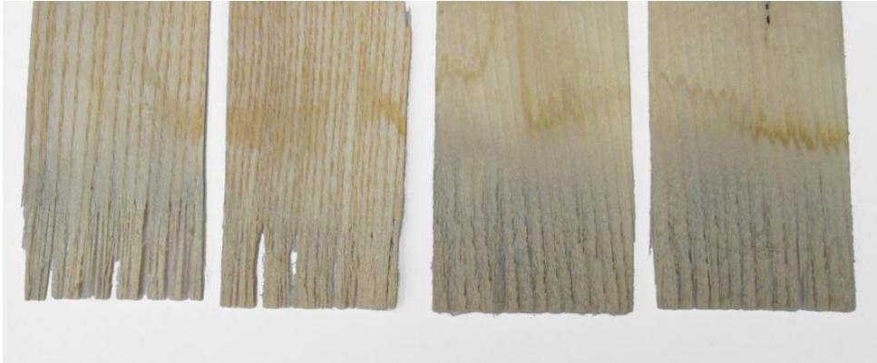
Abbildung 136: Ergebnisse nach dem zweiten Versuch, zwei Esche-Proben (links), zwei Fichtefurniere (rechts)
