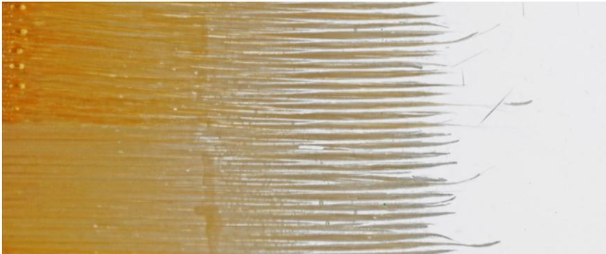
Abbildung 145: Bambusfurnier in Polyesterharz eingebunden (Probekörper:  $l \times b \times h = 120 \times 70 \times 5 \text{ mm}$ )
