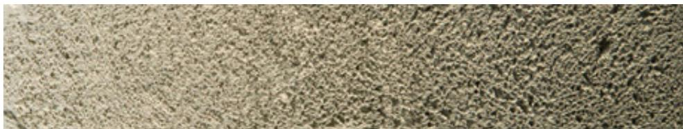
Abbildung 56: Porositätsgradient, geschichtet, Porenbildner (Aluminiumpulver), Prisma 4 x 4 x 16 cm
