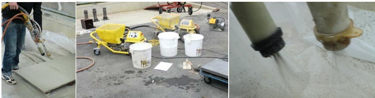
Abbildung 73: Gradientenspritzen durch Variation der Verhältnisse im Sprühnebel
