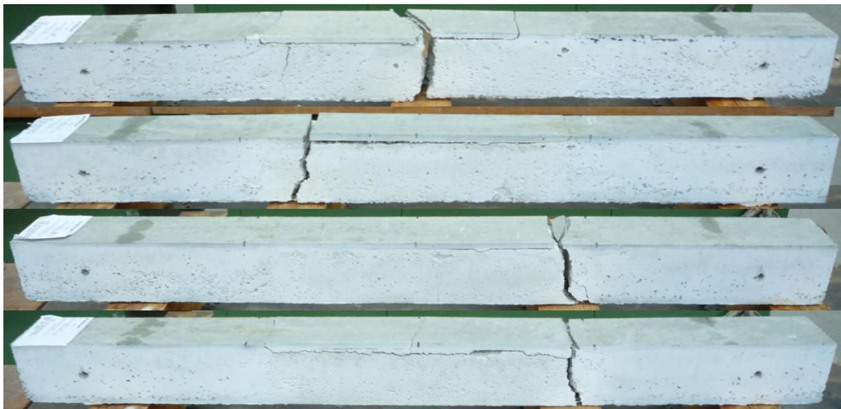
Abbildung 158: SV6: Bruchbilder der Prüfkörper
