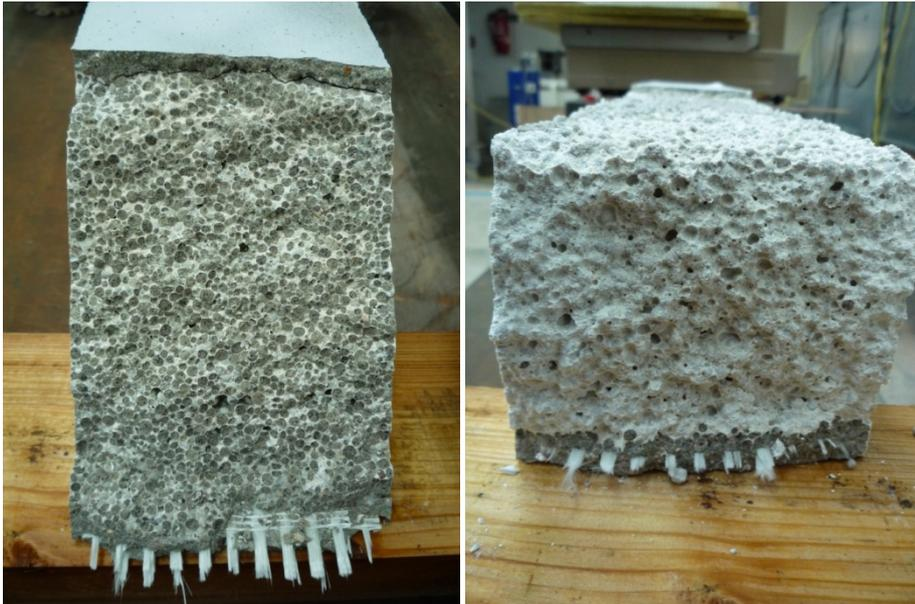
Abbildung 153: Vergleich der Bruchflächen von SV4.1 (links) und SV4.3 (rechts)
