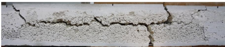
Abbildung 156: Bruchverlauf im Bereich der fehlerhaften KM2 bei SV5.2
