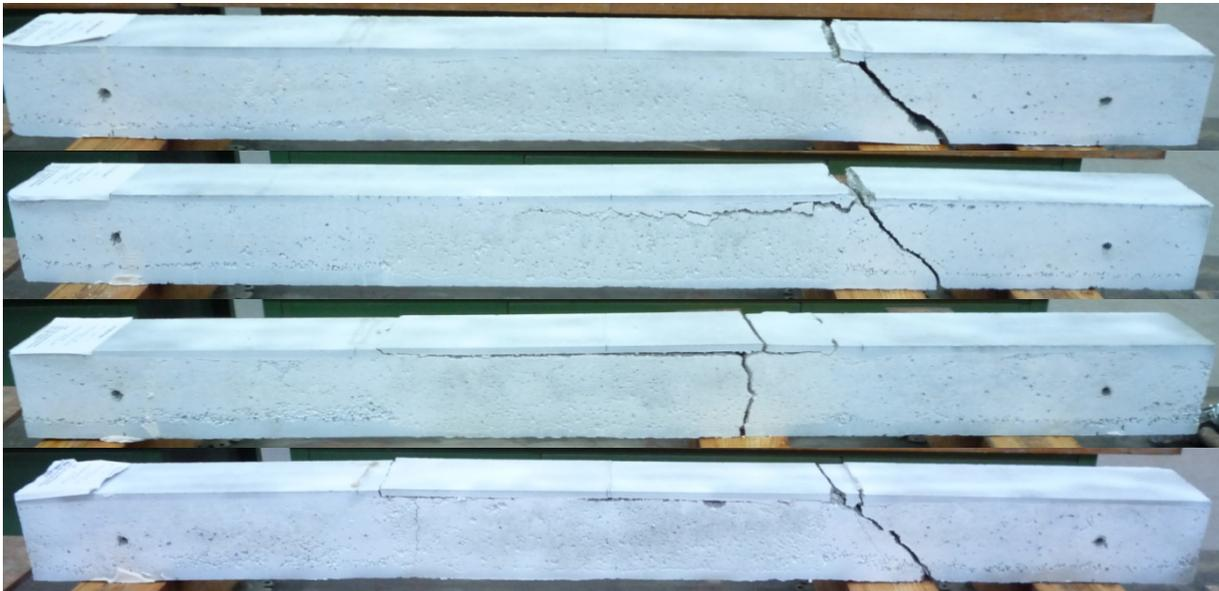
Abbildung 152: SV4: Bruchbilder der Prüfkörper
