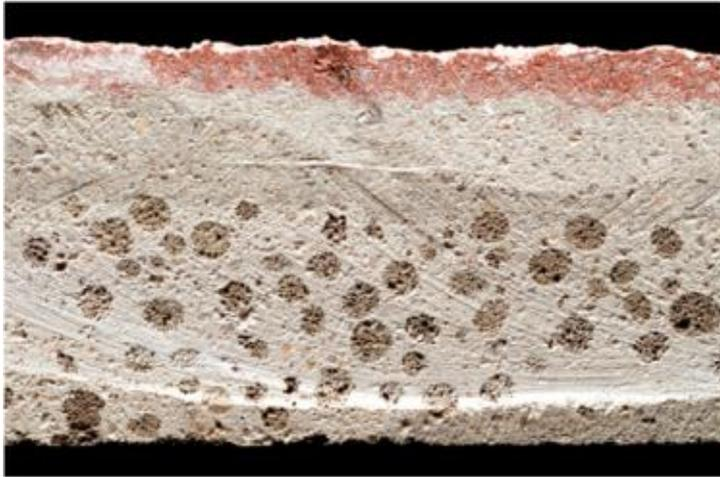
Abbildung 68: *Mehrschichtbauteil (Dicke 2 cm), mit folgendem Aufbau: Deckschicht – Leichtbetonkern – textile Bewehrung – Pigmentierte Oberfläche*
