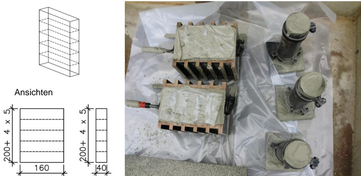
Abbildung 74: Gradientenprobekörper, die in 5 Mörtelprismen aufgeteilt werden können (links); gefüllte Schalungen (rechts)
