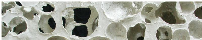
Abbildung 62: Platzhalter: Paraffin, thermisch herausgelöst (Porendurchmesser: 10 bis 50 mm)
