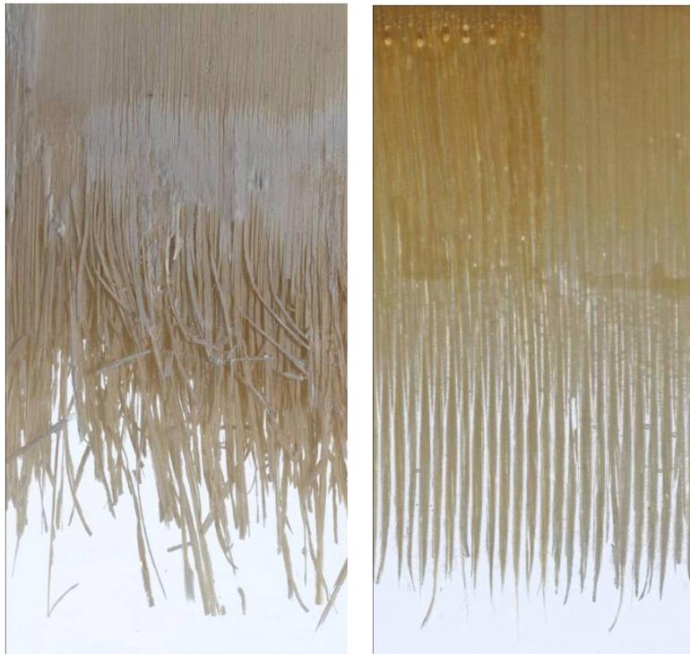
Abbildung 141: Bambusfurnier: mit der Säge aufgeraut und zu mehreren Schichten verklebt (Probekörper:  $l \times b \times h = 140 \times 90 \times 7 \text{ mm}$ ) (links), mit Metallbürste bearbeitet und in Polyesterharz eingelassen (Probekörper:  $l \times b \times h = 120 \times 70 \times 5 \text{ mm}$ ) (rechts)
