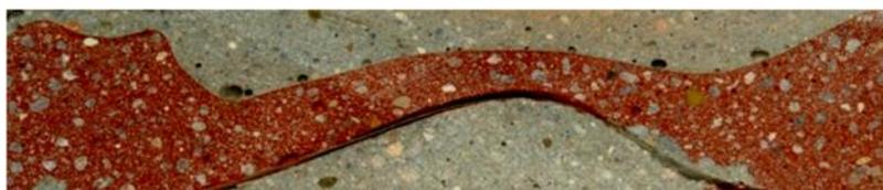
Abbildung 63: Alkalisch lösliche Trennlagen zwischen verschiedenen Betonmischungen (Prisma 4 x 4 x 16 cm)
