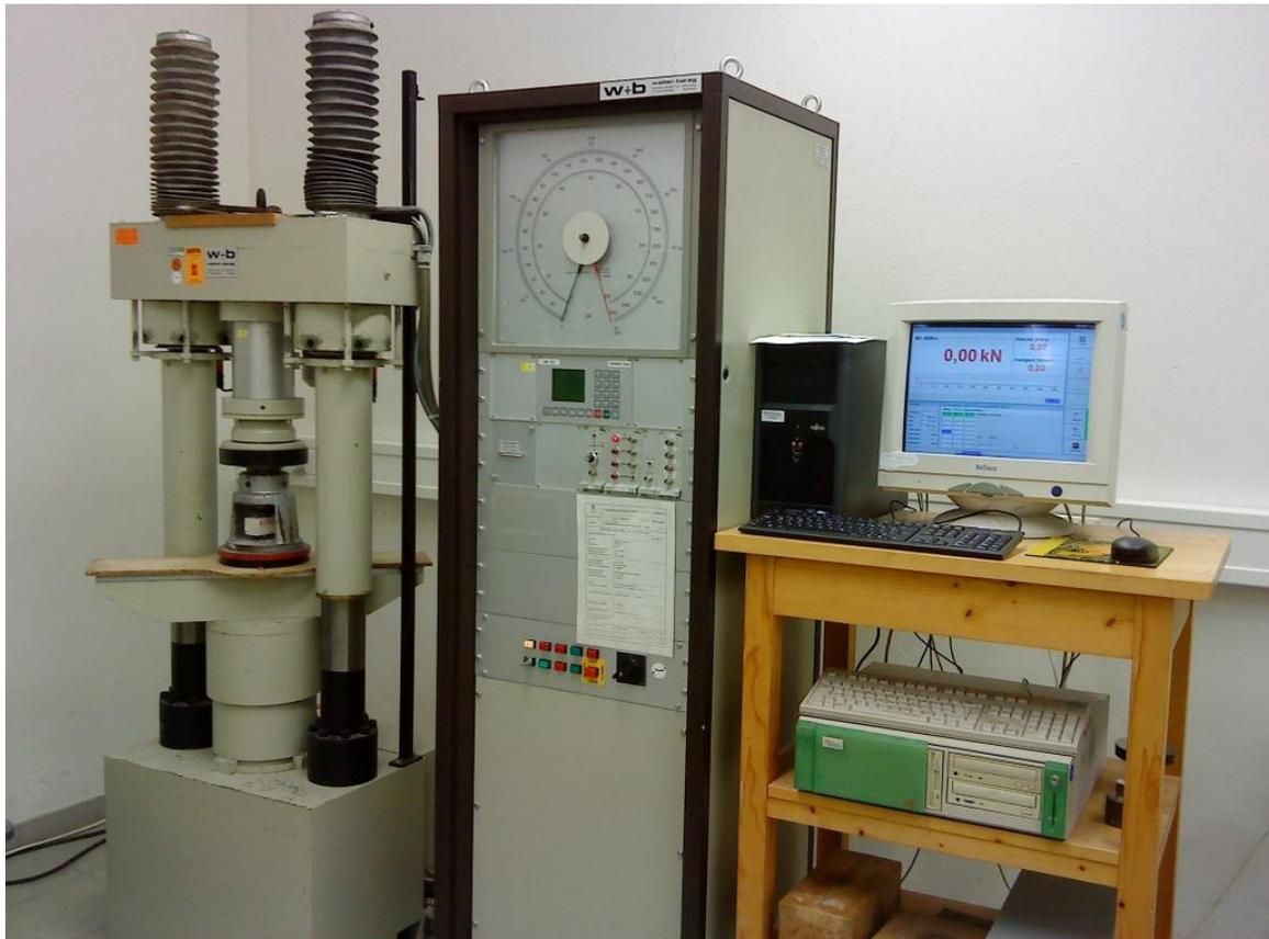
Abbildung 26: Druckpresse mit Messeinrichtung
