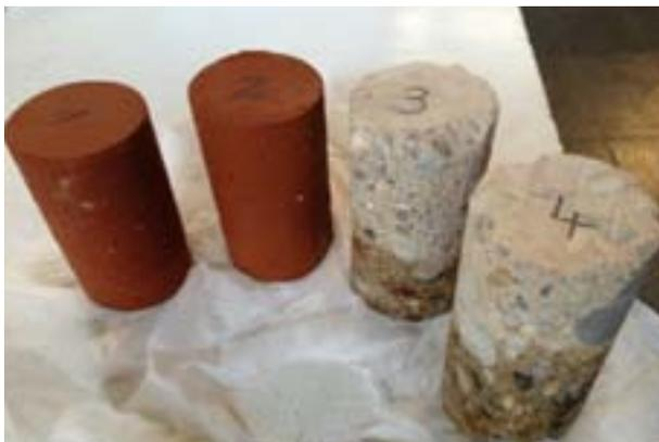
Abb. 100 Bestimmung des Wasseraufnahmekoeffizienten der Bohrkerne (Fotos: Höflich)
