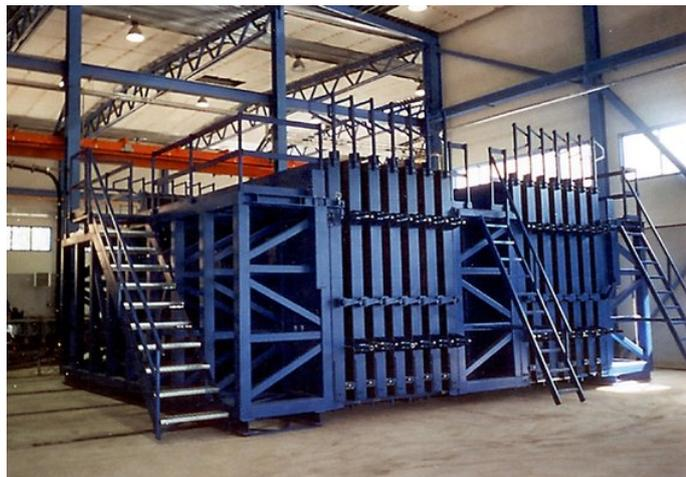
Bild 10: Batterieschalung für die gemeinsame Fertigung von Wand- und Deckenplatten (Kinast Maschinensysteme GmbH 2010)
