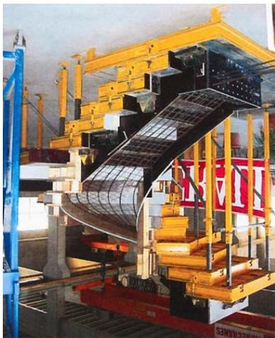
Bild 9: Schaltung zur Herstellung von Wendeltreppen (Kuch, Schwabe und Palzer 2010)
