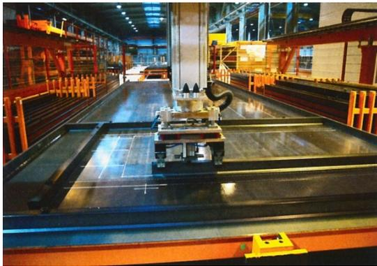
Bild 7: Schalungsroboter zur Fixierung von Aussparungen und Leitungen (Kuch, Schwabe und Palzer 2010)
