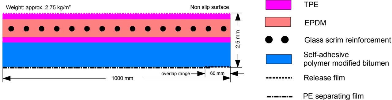
Bitumen – verträgliche, Heißluft verschweißbare EPDM-Synthesekautschukabdichtungsbahn
