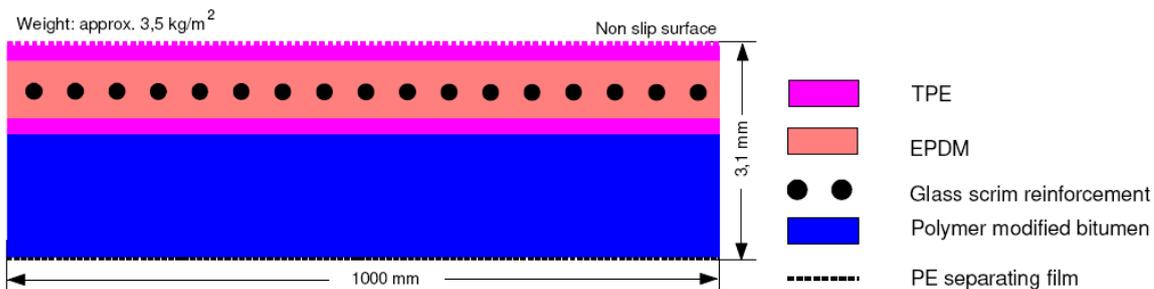
Bitumen – verträgliche, Heißluft verschweißbare EPDM-Synthesekautschuk-Abdichtungsbahn
