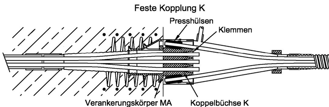
SUSPA - Litzenverfahren 150 mm<sup>2</sup> mit nachträglichem Verbund nach DIN 1045-1, DIN EN 1992-1-1 und DIN-Fachbericht 102
