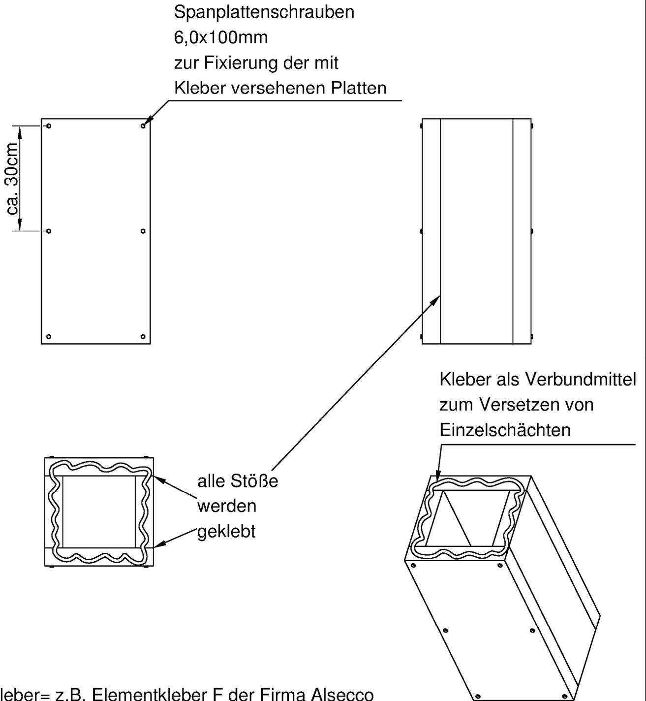
Aussenschale aus Porenbeton L90
