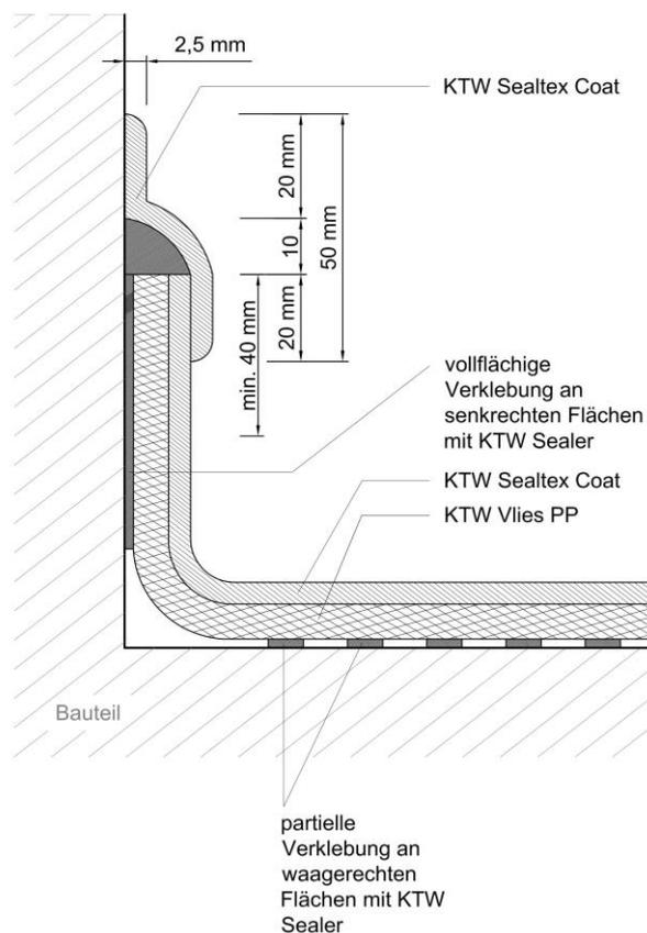
Bild 2: vertikale Anschlüsse und Verlegung an senkrechten und stark geneigten Flächen durch Verklebung auf dem Untergrund, Hohlkehlen sind auszufüllen
