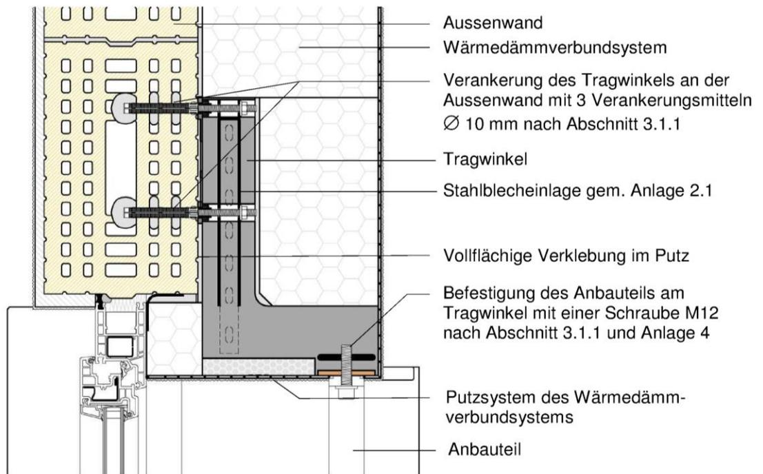
Tragwinkel "TWL-ALU-RF" und "TWL-ALU-RL" für die wärmebrückenarme Befestigung von Anbauteilen in Wärmedämm-Verbundsystemen
