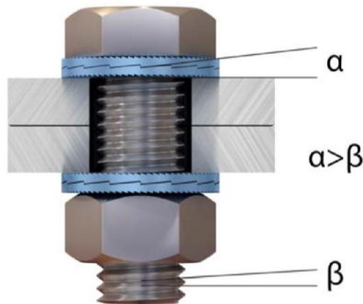
Schematische Darstellung einer Durchsteckverbindung mit zwei Nord-Lock Keilsicherungsscheiben
