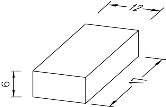
ZZ-Brandschutzsteine 170 BDS-N können längs oder quer in die Bauteilöffnung eingebaut werden. Die min. Schottdicken gem. Abschnitt 1.1.3 und Anlage 22 sind einzuhalten.
