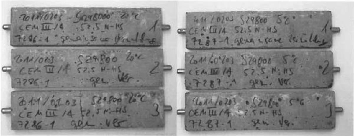
Bild A1: Probekörper aus CEM III/A 52,5 N-SR "Ennigerloh" nach 180 Tagen;
