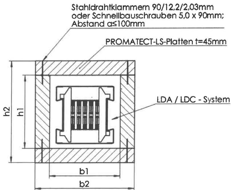
Bild A2.2 Ansicht der 4-seitigbekleideten Stromschienenkanäle ohne Querstoßverbindungsmuffen und ohne innere Lastverteilerplatte
