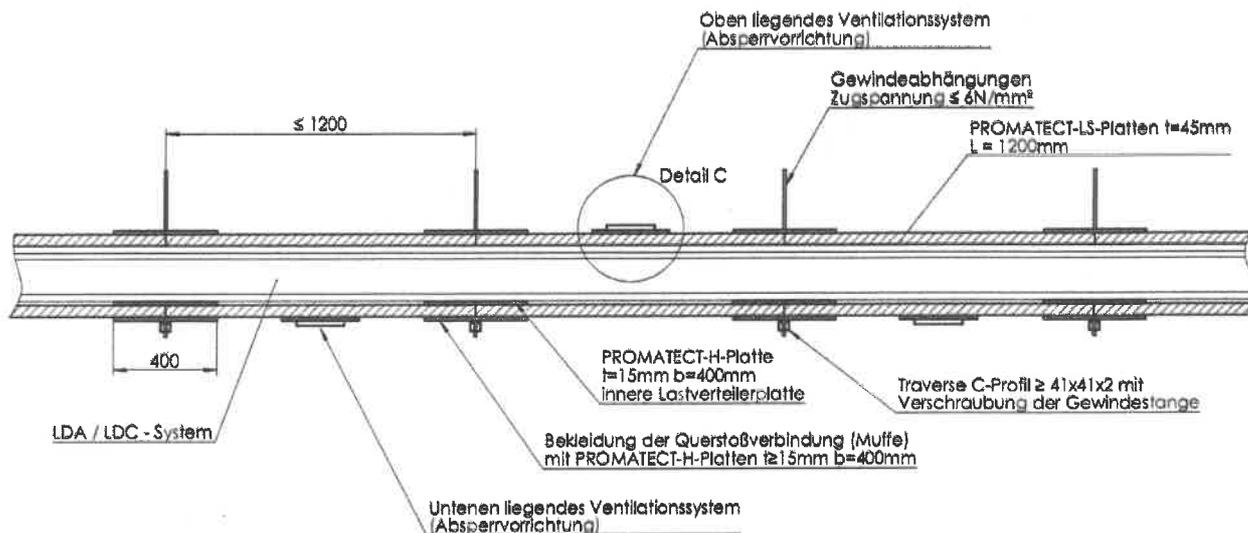
Bild A2.1 Ansicht der 4-seitig bekleideten Stromschienenkanäle mit Schnitt durch die Verbindungsmuffen; Horizontalinstallation
