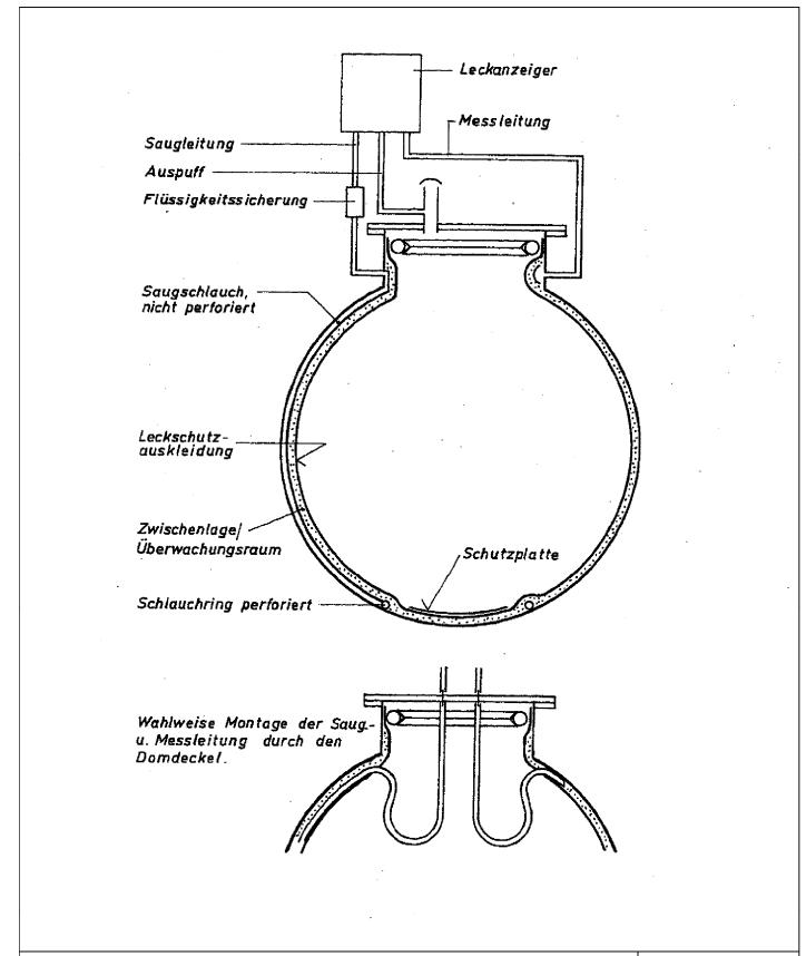
Leckschutzauskleidung Typ "WH..-ÖL" und Typ "WH..-TLT" als Teil eines Leckanzeigegerätes für Behälter zum Lagern von Ölen und Kraftstoffen
