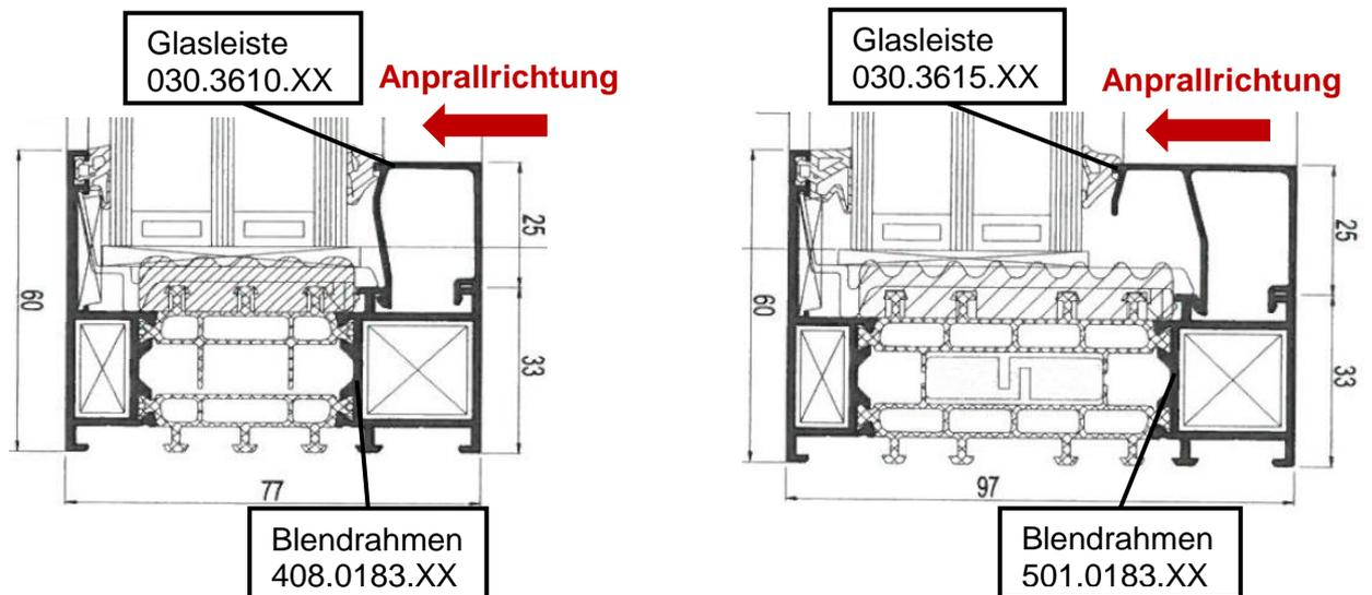
**Bild 3** Festverglasungen „Functional“ Masterline 8 (links) und Masterline 10 (rechts)
