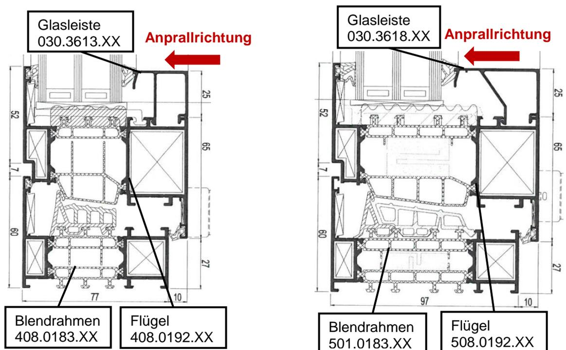
**Bild 4** Drehkippenfenster „HID“ Masterline 8 (links) und Masterline 10 (rechts)
