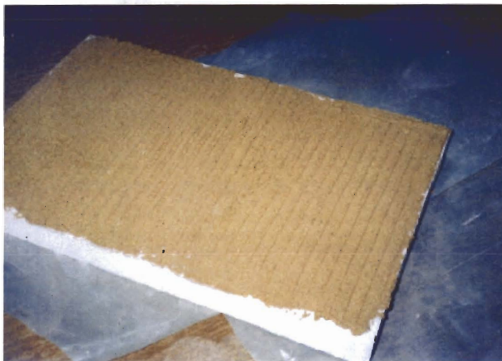
Abb. 3: Dämmplatte aus Calciumsilikat vor dem Einbau mit aufgebrachteter Koppelschicht aus Lehmputz
