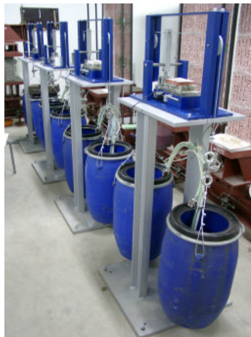
Bild B6: Schematischer Versuchsaufbau (links) und Versuchsstände zur Bestimmung des Zug-Verformungs-, Kriech- und Relaxationsverhaltens und der Rissüberbrückungsfähigkeit von Putzinstandsetzungssystemen (rechts)
