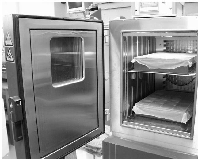
**Abb. 1:** Simulationsschrank mit Probenhalterungen für die Versuche bei verschiedenen Temperaturen und Luftfeuchten
