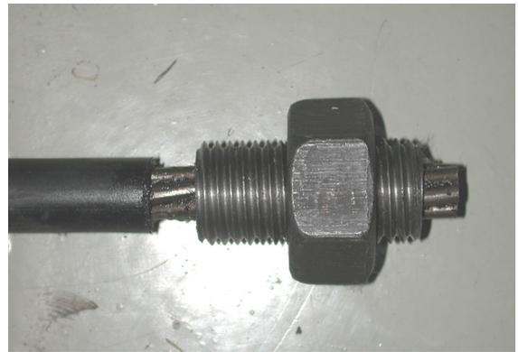
Bild 2: Losanker als Schraubverankerung
