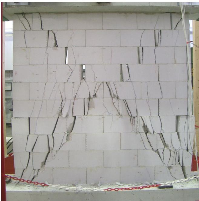
Bild 11: Bruchbild von Wand W1
