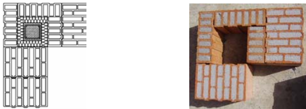
Abbildung 6: Ausführung des Zugglieds als Betonzugstütze [15]
