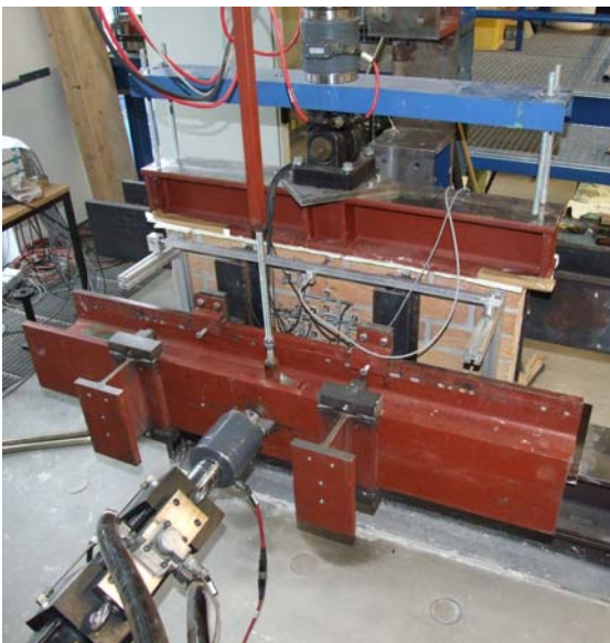
Bild 5: Versuchseinrichtung zur Bestimmung der Biegezugfestigkeit parallel zu den Lagerfugen mit Auflast (links) und Kraft-Durchbiegungs-Linien (mittlere Mittendurchbiegung) der Mauerwerkswände aus Vollziegeln W2 mit Normalmörtel bei verschiedenen Auflaststufen
