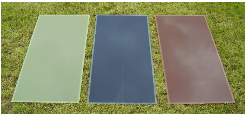
Abbildung 2 hergestellte Prototypen der farbigen Dünnschicht-PV-Module für VH-Fassaden
