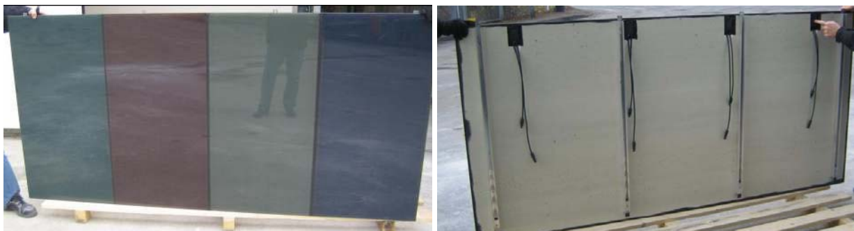
Abbildung 4 PV-Element nach der Bewitterung; links: Frontseite mit optischer Trübung der Folie im Kantenbereich; rechts: Rückseite mit Anschlussdosen und Unterkonstruktion aus vertikalen T-Profilen und Laschenprofilen aus Aluminium
