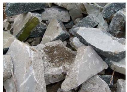
**Bilder 1 bis 3:** Ausgangsmaterial: sortenreines Mauerwerk-Abbruchmaterial (Beispiel)
