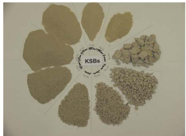
**Bilder 7 und 8:** Zerkleinertes Kalksandstein-Recycling-Material (Beispiel)
