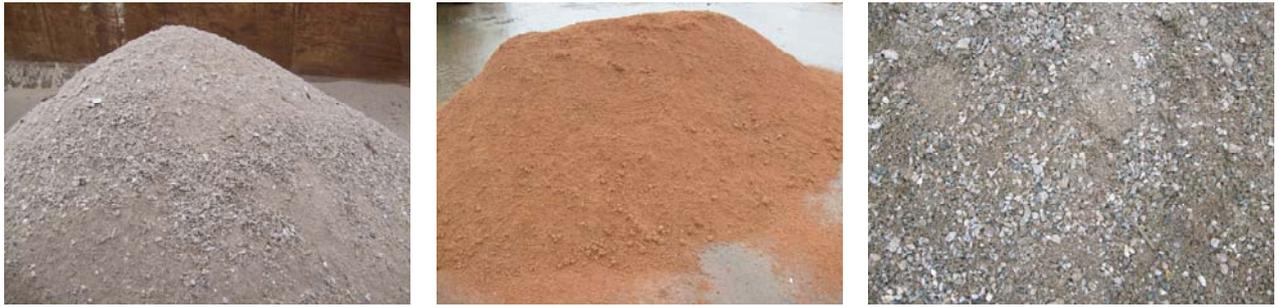
**Bild 4 bis 6:** Recycling-Bruchmaterial der Fraktion 0/5 mm
