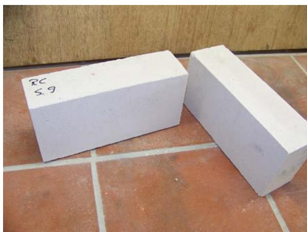
**Bild 11:** Prüfkörper der Serie 9 - Zugabe von 50 M.-% Kalksandstein-Recycling-Material der feinen Fraktion 0/2 mm (Beispiel)
