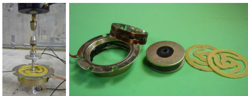
Bild 2: Fotografie des Modellaufbaus mit starrer Verbindung zur Bodenplatte und Bauteile des verwendeten Aktors.
