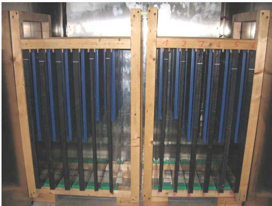
Abbildung 3 Lagerung der MIG in der Klimakammer mit Zusatzgewichten (blau) zur Simulation größerer Formate und Scheibenaufbauten
