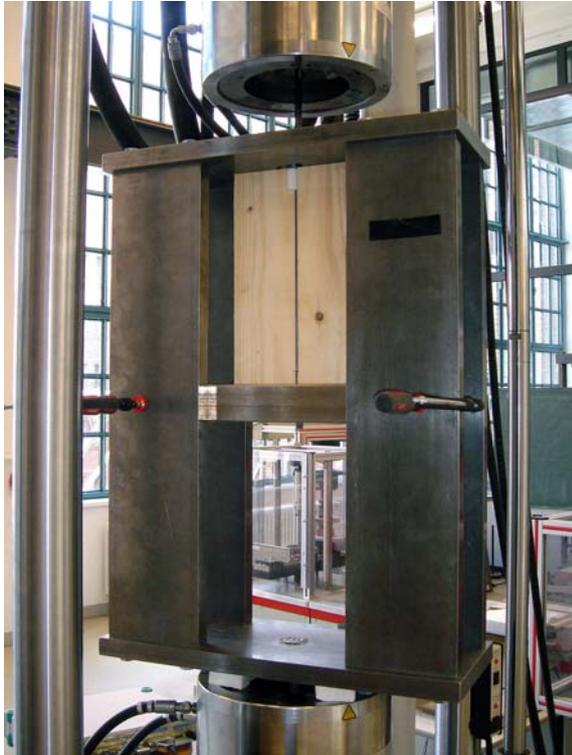
**Abbildung 2:** Auszugversuch am Holz/CFK-Verbundprobekörper
