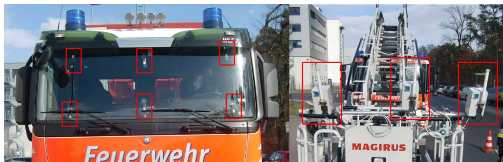
Abbildung 6: Versuchsequipment der Reichweiten- / Genauigkeitsmessung (links: Mit Transpondern bestückter LKW; rechts: Mit i-SATs bestückte Drehleiter) (Bildquelle: Hr. Fabian, Identec Solutions)
