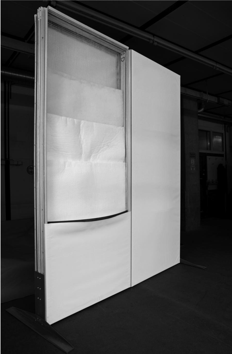
Bild 4 : Demonstrator zweier Gebäudehüllensegmente (Höhe 3m, Breite 2,4m)
