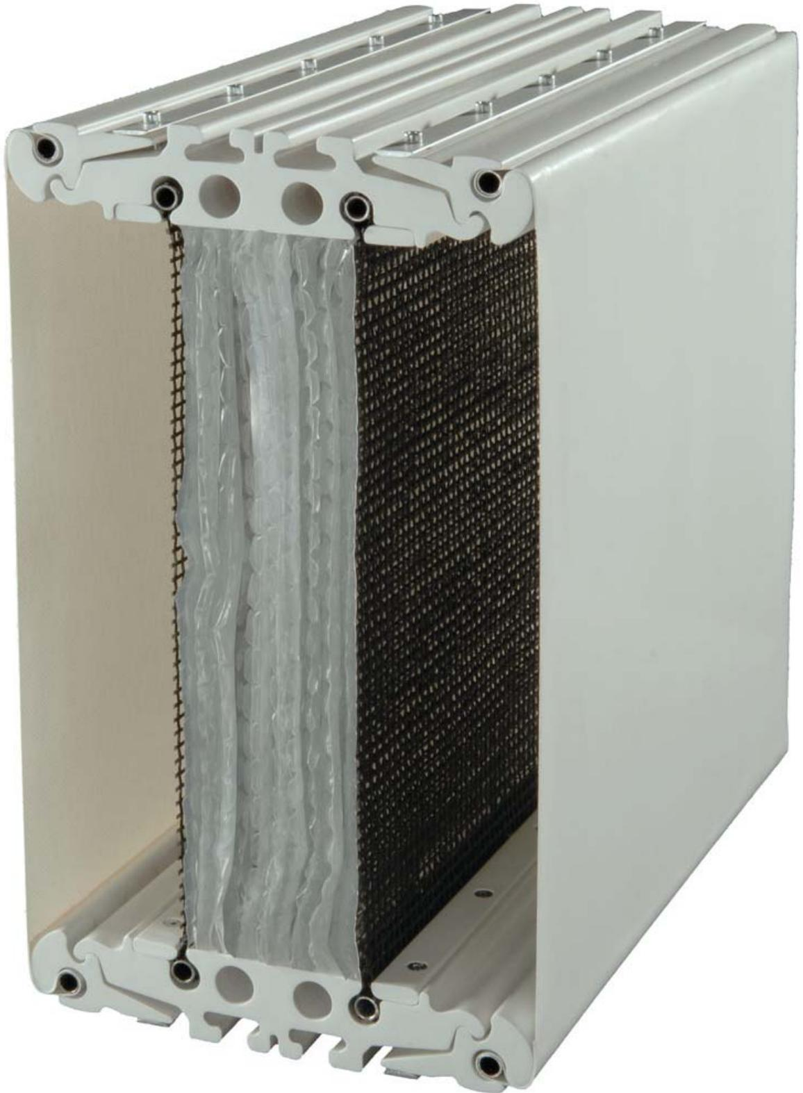
Bild 3: Mock Up der textilen Gebäudehülle
