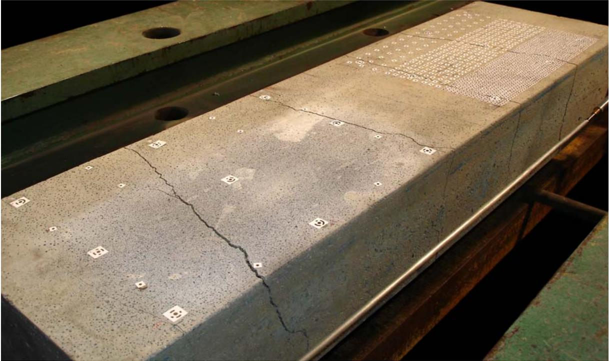
Bild 1: Probekörper für die Untersuchung geeigneter Oberflächenstrukturierungen und zur Detektion von lokal erhöhten Dehnungen
