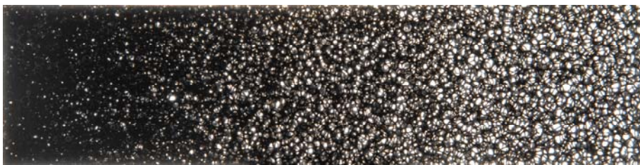
(Bild 1: Gradiertes PUR-Schaum in Polyesterharz, Quelle: ILEK)
