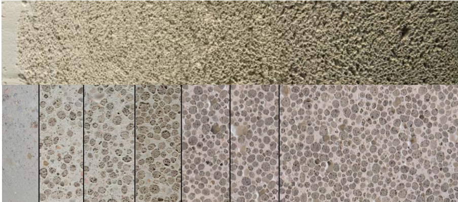
(Bild 2 oben: Dichtegradierte Porenbetonprobe, Quelle: ILEK; Bild 2 unten: Homogene Betonmischungen in Stufen gradierter Dichte zur Materialprüfung [2] , Quelle: ILEK)
