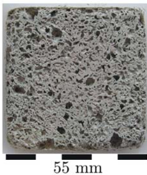
Bild 2: Papierplatte ca. 5 % Brandhemmer hergestellt mit Triebmittel.
