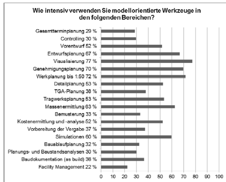
Abb. 2 Nutzung modellbasierter Softwaretools in verschiedenen AEC-Prozessen
