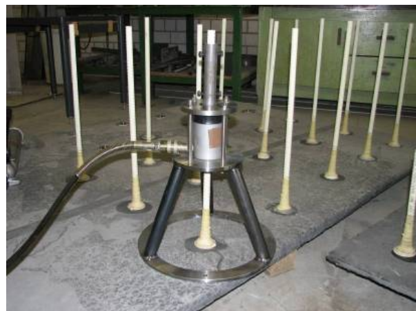
Abbildung 5: Haftzugprüfung der GfK-Beton-Verbindung
