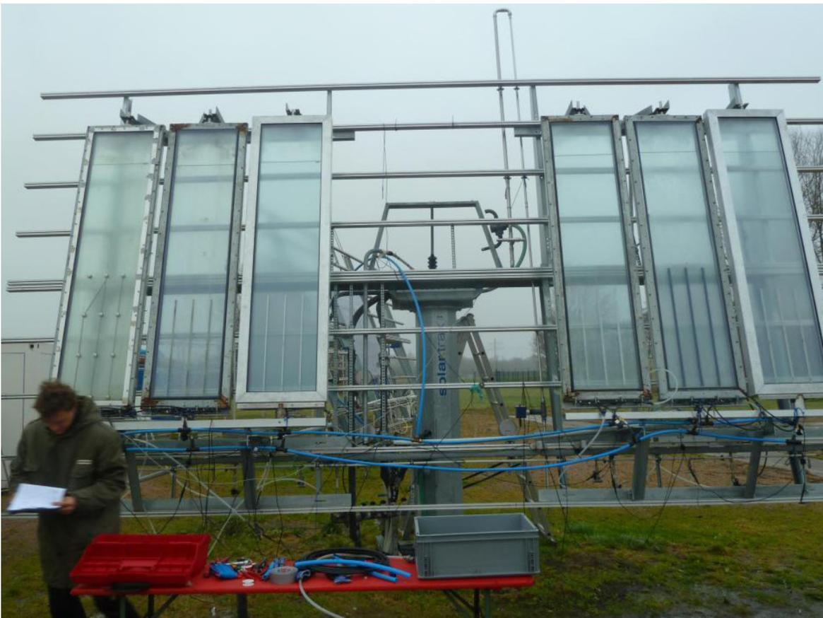
Abbildung 8 Einstellung von gleichen Füllhöhen in sechs PBR. Die jeweils linken PBR sind Prototypen der ersten Generation, die jeweils rechten jene der zweiten.
