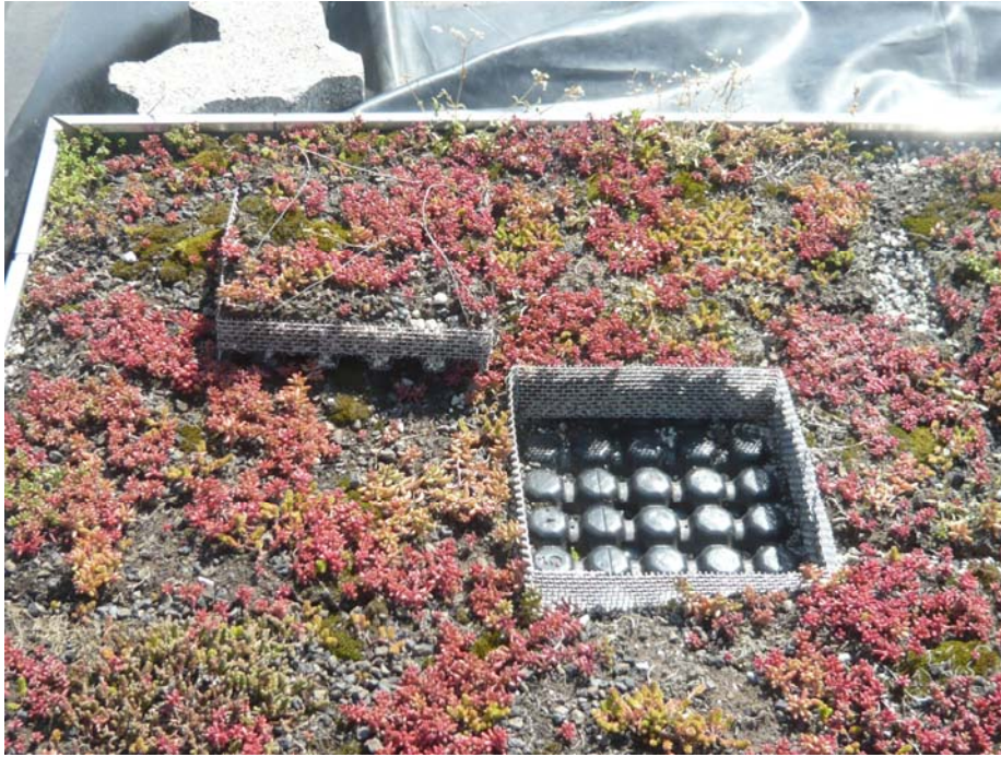
In die Versuchsfelder integriertes Substratkörbchen zur manuelle Wägung und Erfassung der Substratfeuchte.
