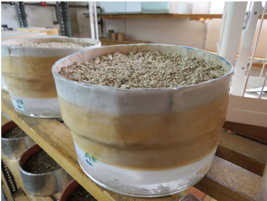
Probekörper zur Bestimmung der Materialeigenschaften der verschiedenen Substrate im Labor (hier: Diffusionswiderstand).
