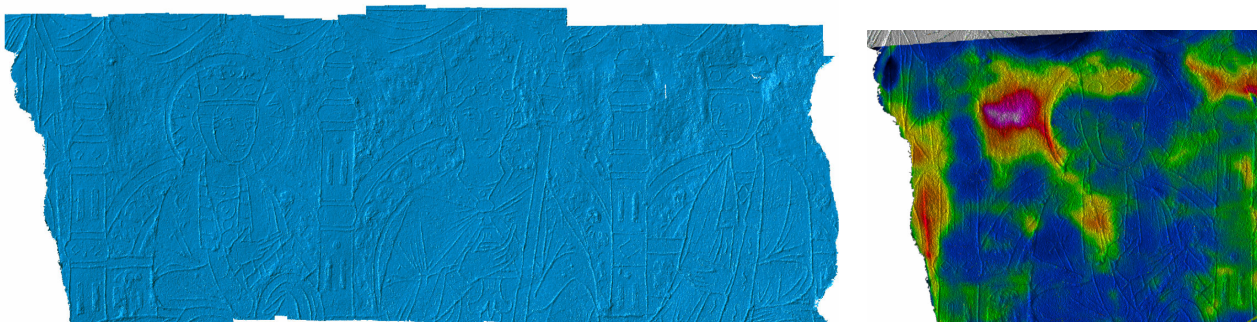
Abb. 6: Visualisierung der Putzritzen. Links: 3D-Datensatz als Ergebnis der Photogrammetrie. Rechts: Überlagerung eines Teilbereiches mit einem Thermogramm, das vom Baugerüst aus erfasst wurde.
