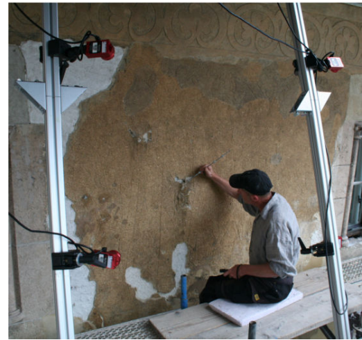
Abb. 1: Trackingsystem mit Tastsensor im Einsatz
