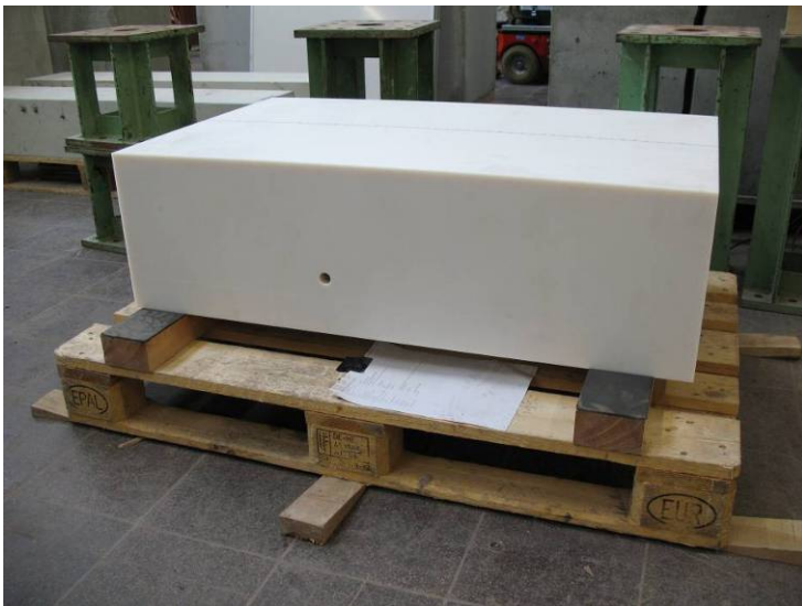
Abb 2 Darstellung des Referenzkörpers aus Polyamid
