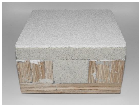
Bild 6: Probe aus Holzwerkstoff (Multiplex) und Absorberstreifen aus offenzelligem Glasschaum mit lose aufgelegter Glasschaum-Platte und Putzschicht.
