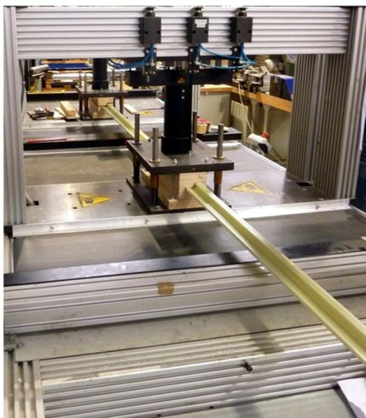
Bild 4: Abziehen der Ausgehärteten Fensterprofile
