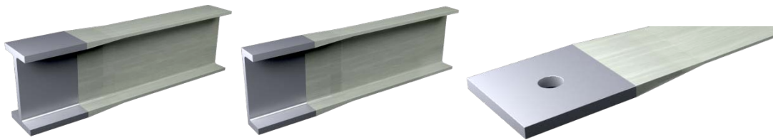
Abbildung 1-1 Visualisierung des Lösungsansatzes am Beispiel verschiedener Profile aus GfK; links : Doppel-T-Profil; mittig : U-Profil; rechts : Flachprofil
