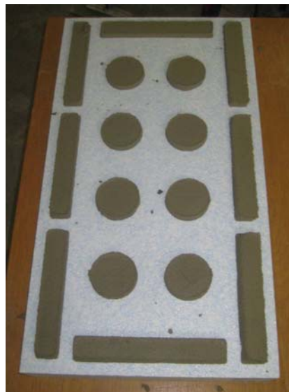
Bild 2: Dämmstoffplatte mit Klebemörtel vor Befestigung auf der Grundwand (Klebeflächenanteil 40 %). Der Mörtel wurde mittels einer Schablone aufgebracht, so dass sich für alle Aufbauten genau gleiche Bedingungen ergaben.
