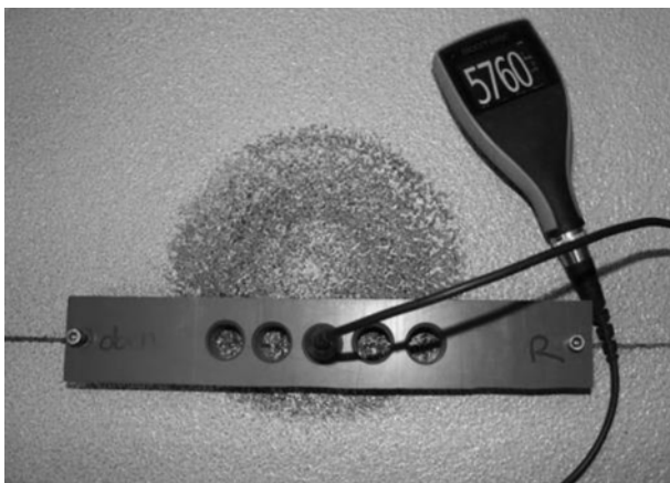
Bild 5: Magnetisch-induktives Messverfahren – Gerät zur Schichtdickenmessung
