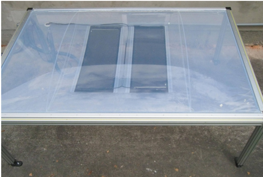
Bild 2: Freibewitterungsprüfstand des ETFE-Kissen-Prototyps mit innenliegenden PV-Modulen
