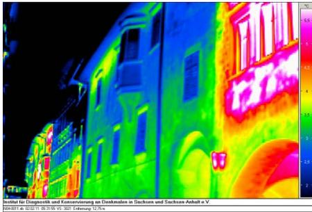
Bild 1: Waaghause, Bozen, IR-Aufnahme Fassade
