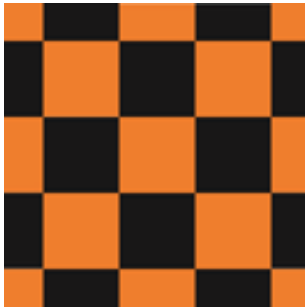
Bild 3: Resonatoranordnung "8|8" auf 1.5 mm dicker Stahlplatte mit 25 cm Kantenlänge (orange: Resonatoren; schwarz: unbesetzter Teil der Platte). © Fraunhofer IBP
