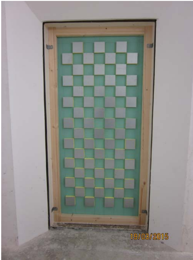
Bild 5: Gipskarton-Platte mit 56 Resonatoren (1.5 mm Stahl auf 25 mm Sylomer, Kantenlänge 10 cm) in der Prüföffnung des Türprüfstands. © Fraunhofer IBP
